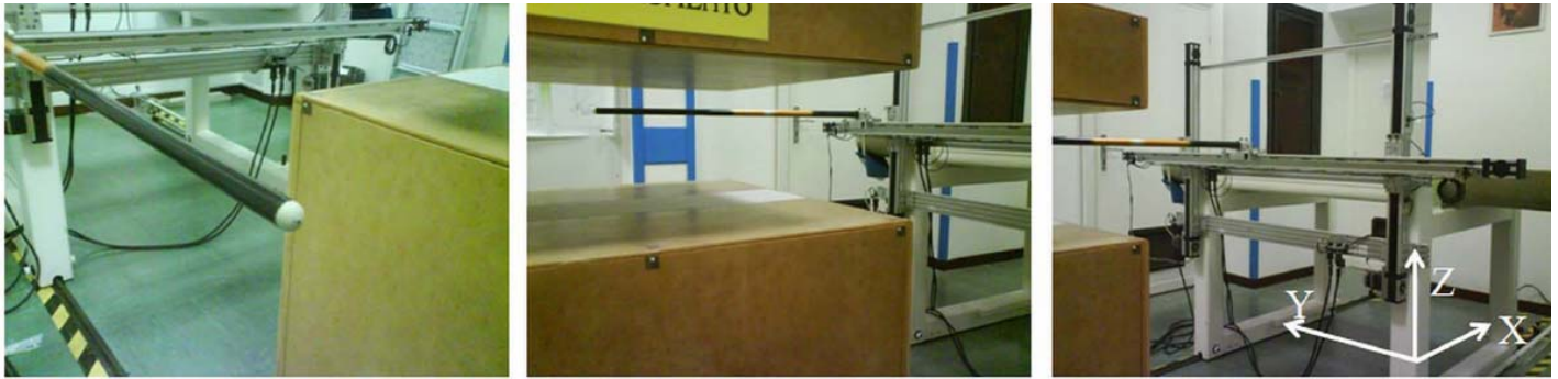
Figura 2: Sistema per la misura della mappa di campo. (A): la sonda montata sul supporto con deboli proprietà magnetiche. (B): Sostegno della sonda montato sul carrello mobile. (C): Sistema di movimentazione assemblato sulla barella.
